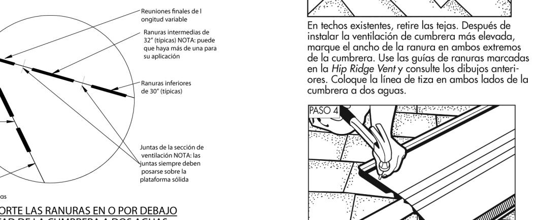
Fig. 1 NUNCA CORTE LAS RANURAS EN O POR DEBAJO DE LA MITAD DE LA CUMBRERA A DOS AGUAS
